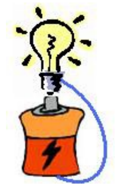
Sluten strömkrets med en ledning.
